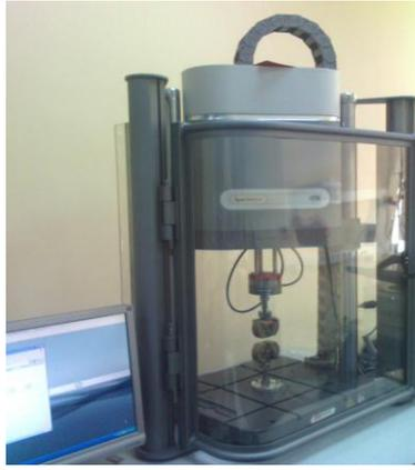
Рисунок 2.13 – Разрывная машина Instron Electropuls E1000.
