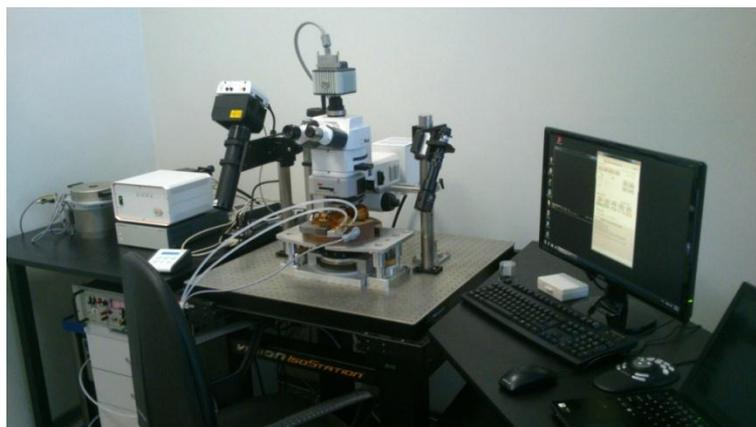
Рисунок 2.20 – Внешний вид магнитооптического микроскопа с реализацией эффекта Керра
