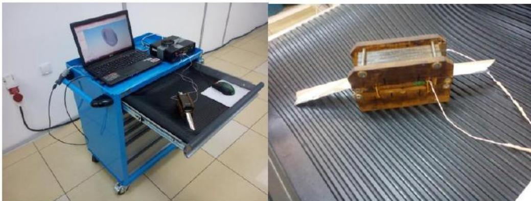
Рисунок 2.1 – Стенд по определению распределения намагниченности с однополосочным пермеаметром
