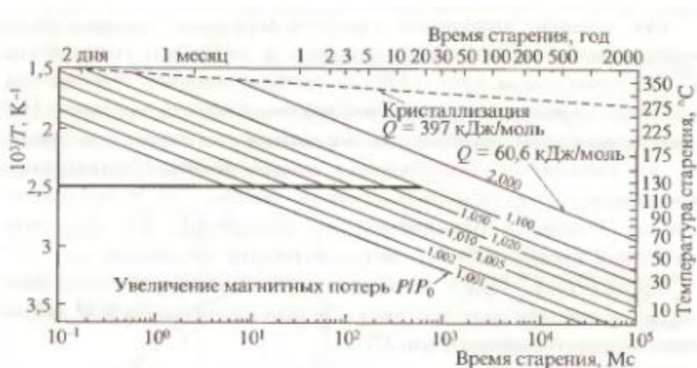
Рисунок 1.18 – Связь между временем старения и температурой старения для заданного увеличения удельных магнитных потерь в аморфном сплаве  $\text{Fe}_{80}\text{B}_{12,5}\text{Si}_{17,5}$  с энергией активации  $Q = 60,6$  кДж/моль [30].
