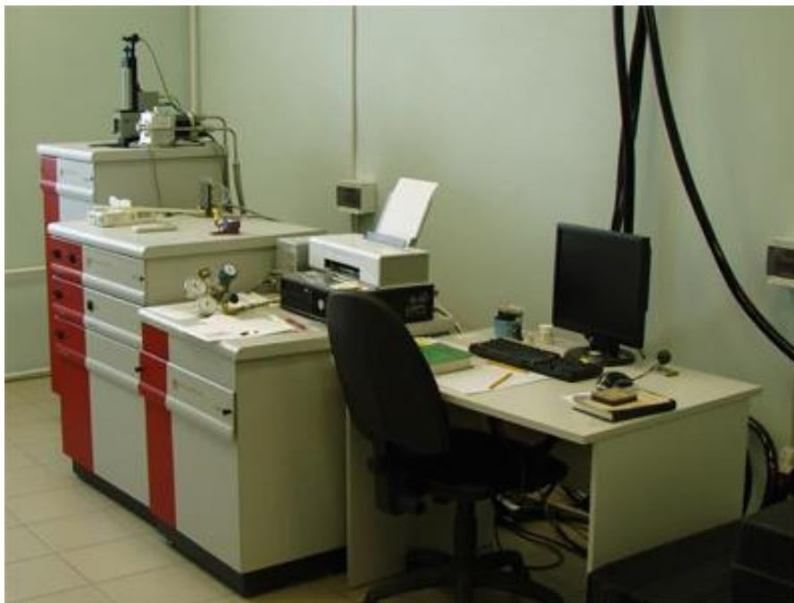
Рисунок 2.4 – Внешний вид SQUID-магнетометра.
