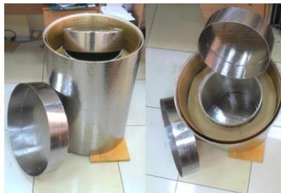
Рисунок 6.2 – Магнитоэкранированная камера на основе металлополимерного магнитного экрана
